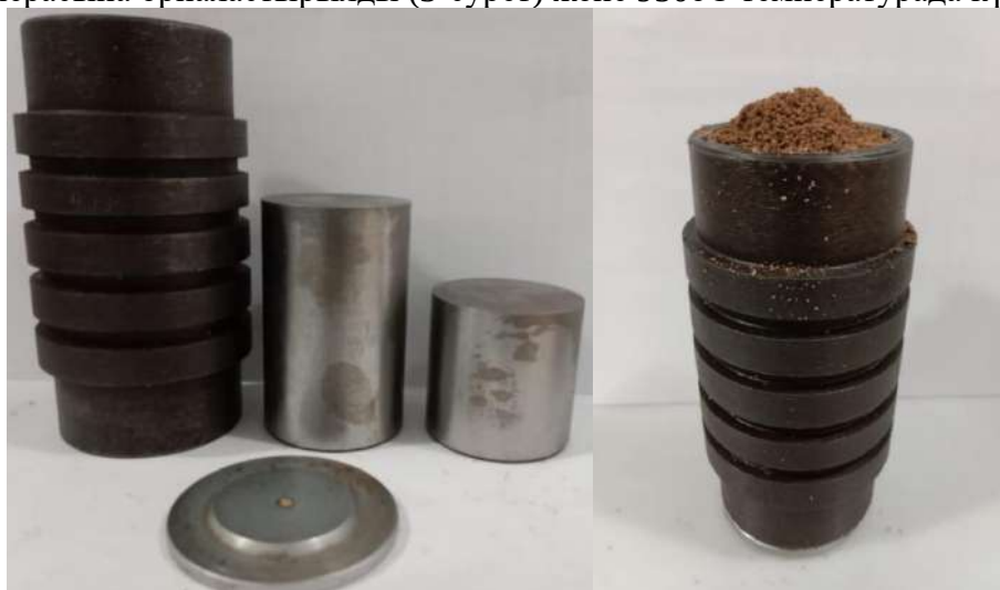
2-сурет – Ø 50 мм шикізат зертханалық үлгілерін алу үшін цилиндрлік нысаны
