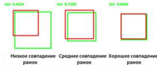
Рисунок 2 – Примеры влияния взаимного положения ограничивающих рамок на метрику IoU
