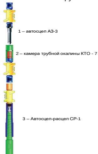
Рисунок 2 Предлагаемая модернизированная система с трубным насосом ННШ
