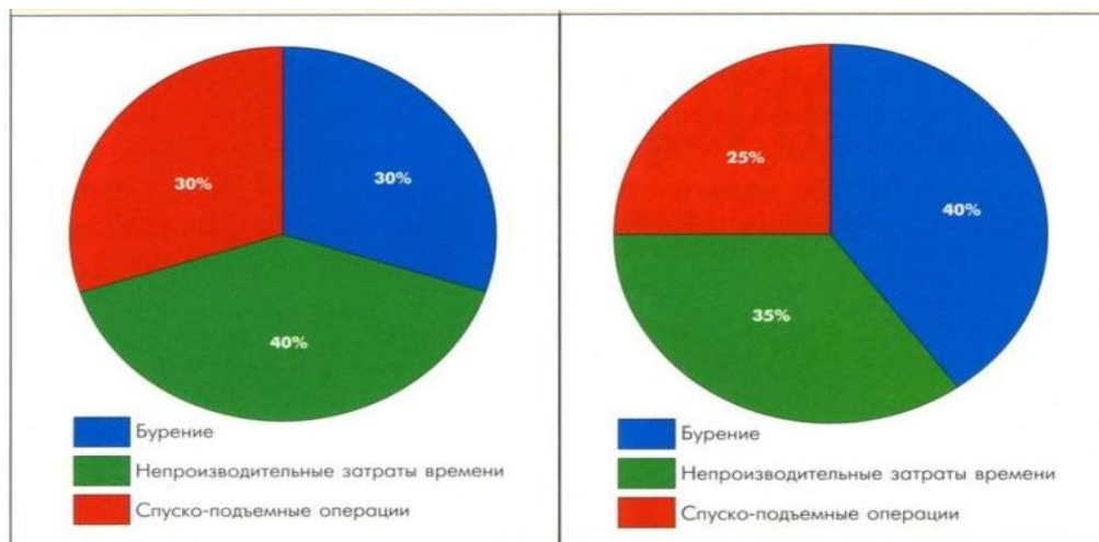
1-сурет - бұрғылау уақытын бөлу диаграммасы - әдеттегі роторлы бұрғылау
