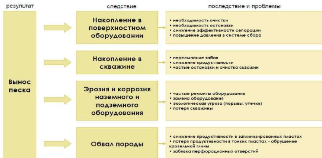
Рисунок 1. Последствия выноса механических примесей
