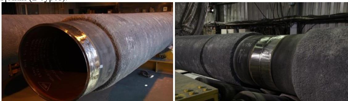
2-сурет - Бетонды қаптамамен құбыр сыртын жабу
