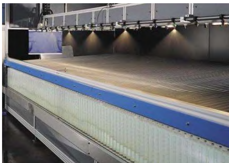
Сурет 3. Бүріккіштің бүріккіш жүйесін өндірістік сынау (Teejet Technologies, Spraying Systems Co)
